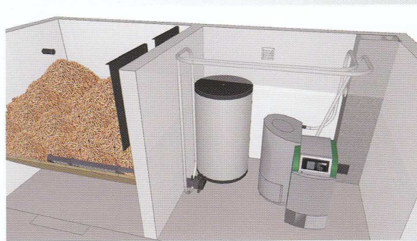
trasporto con coclea e sonda di aspirazione
