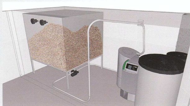
silo a sacco: trasporto con sonda di aspirazione
