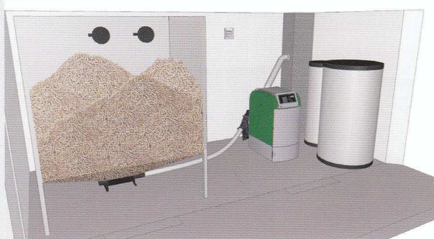
silo a sacco: trasporto con coclea flessibile
